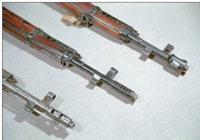
Дульные устройства винтовок Токарева разных моделей (сверху вниз): опытная винтовка 1936 года, СВТ-38, АВТ-40. Форма дульного устройства винтовок СВТ-40 поздних выпусков была такой же, как у АВТ-40.
