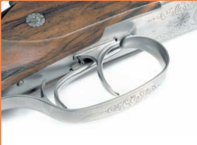
Передний спуск работает на правый гладкий ствол, а при взведённом УСМ нарезного ствола - на нарезной, причём в качестве обычного спуска или шнеллера
