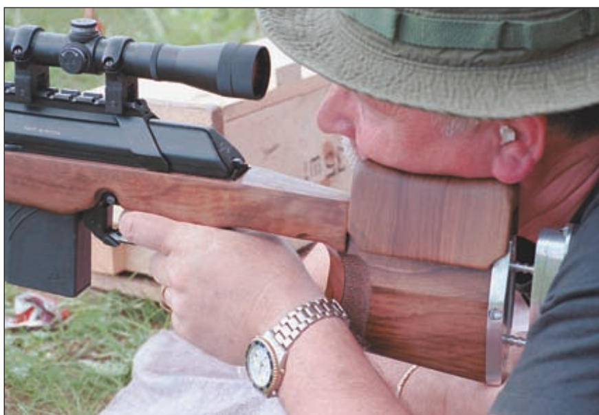
Конструкция ложи карабина «Вепрь–308 Супер–Спорт» позволяет отрегулировать геометрию приклада в соответствии индивидуальными данными стрелка
