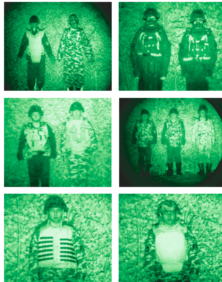
Ил. 2. Защитные чехлы для бронежилетов при наблюдении ночью в ПНВ в условиях ИК-подсветки
