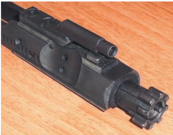
Вид рамы с затвором. Виден толстый слой нагара
