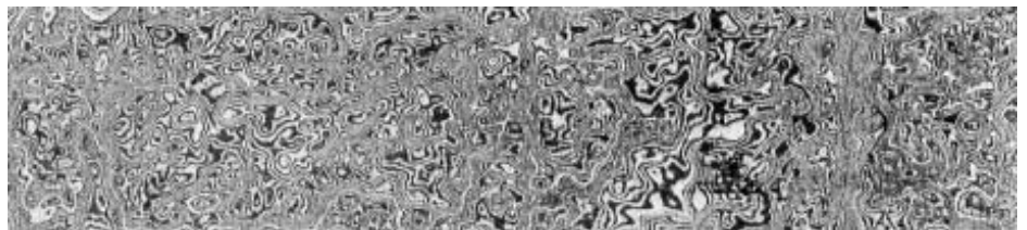
Ил. 5. Элементы типичных узоров старых восточных клинков, воспроизведённые на образце лабораторного экзобулата
