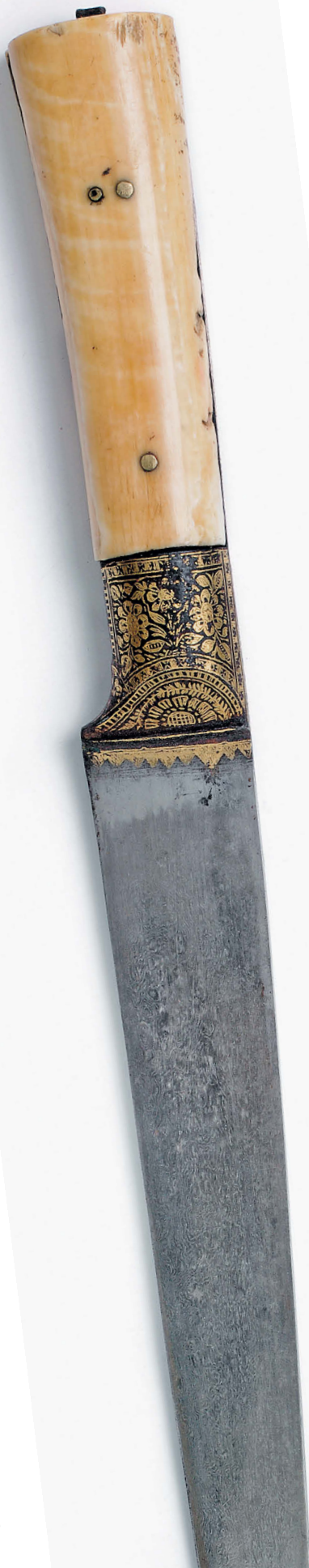
Ил. 5. Элементы типичных узоров старых восточных клинков, воспроизведённые на образце лабораторного экзобулата
