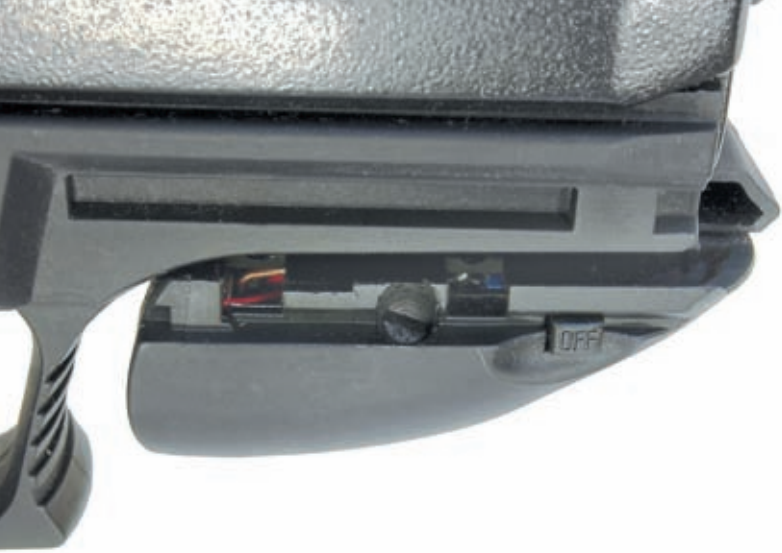
Установка указателя на А-3000 «Скиф», правая половина кронштейна снята. Крепёжный винт, фиксирующий лазерный диод, имеет плоский шлиф. Отверстие под отвёртку для него – в снятой половине
