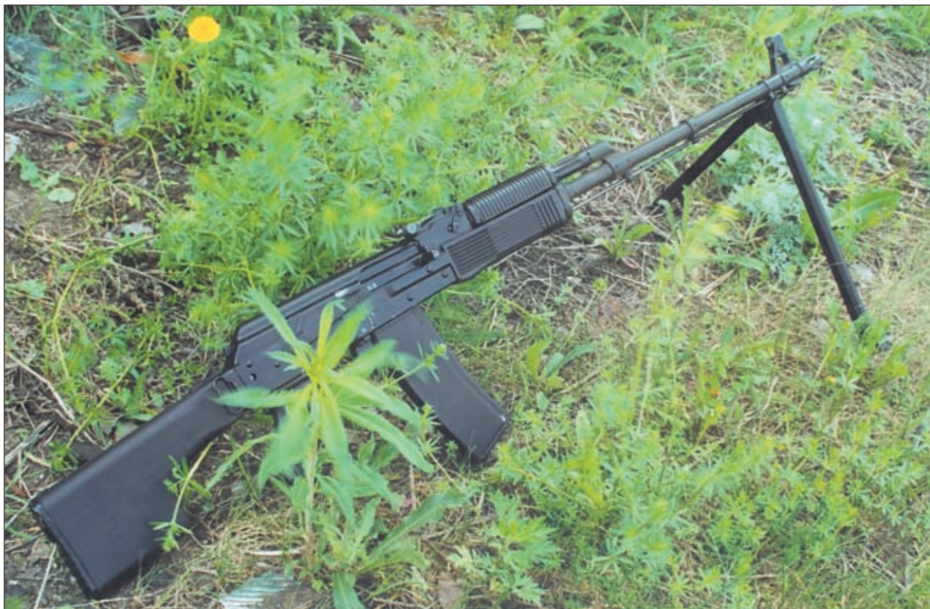
РПК под патрон калибра 5,56x45. На иллюстрации приведено изображение пулёмёта с магазином на 30 патронов от ижевских автоматов «сотой» серии. В будущем пулёмёт получит штатный магазин увеличенной вместимости
