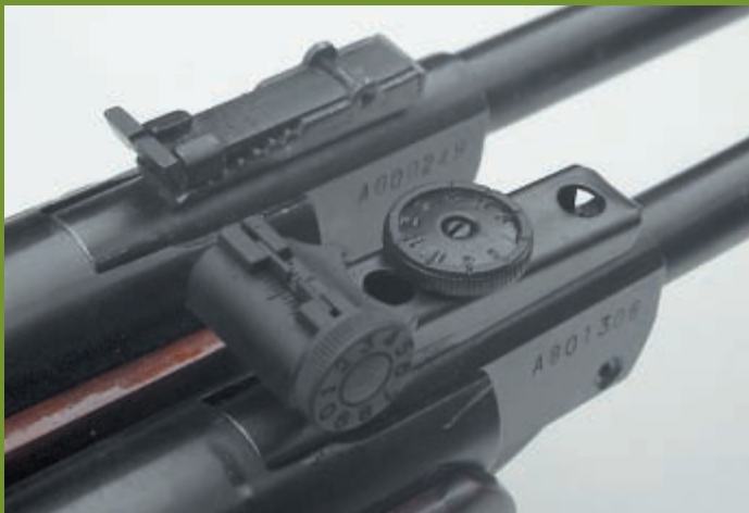
Прицельная планка V1-1 (на втором плане) может занимать всего пять положений по высоте. QB-15 (на первом) имеет более привычную конструкцию прицела с двумя винтами ввода поправок
