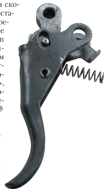
Спусковой механизм QB-15. От механизма V1-1 он отличается только наличием заднего выступа спускового крючка, взаимодействующего с предохранителем. Шептало и крючок располагаются на одной оси
