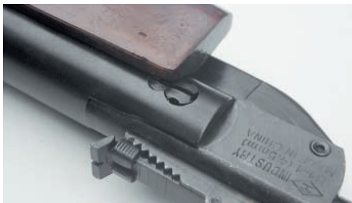
Ось вращения у обеих винтовок фиксируется за счёт дополнительного винта, входящего своей головкой в один из четырех вырезов головки оси (а хотелось бы, чтобы в один из шести или даже восьми)
