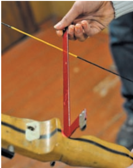
Для создания гнезда изначально измеряем базу. Она должна составлять от 21 до 23 см. Мы всегда делаем 22,5 см
