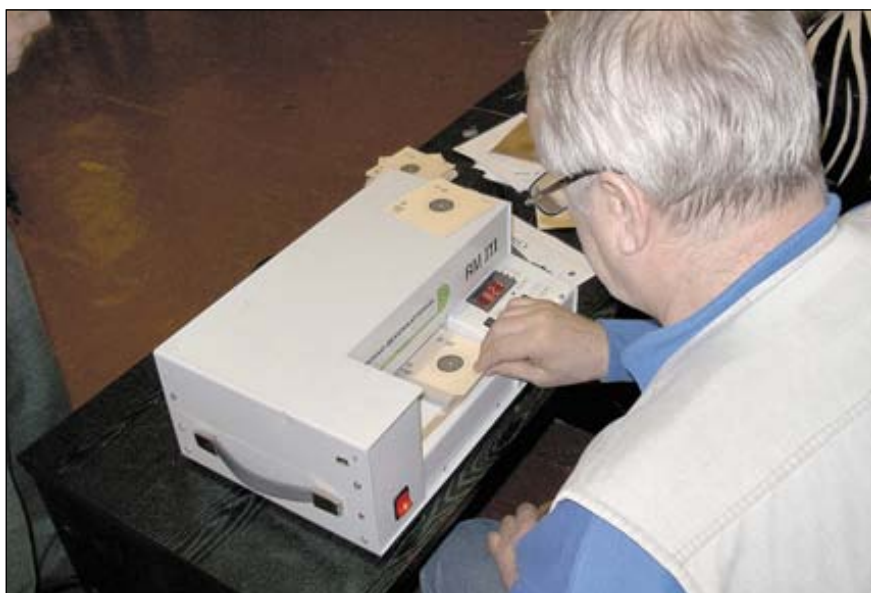
При проведении финальных стрельб достоинство пробиты определяется с точностью до десятых с помощью специального сканера
