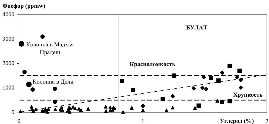
Рис. 4. Зависимость содержания фосфора от концентрации углерода. Квадраты – это результаты наших исследований, ромбы – результаты анализов американских исследователей, кружки – наши исследования состава индо-персидских оружейных сталей XVII века, треугольники это содержание углерода и фосфора в современных сталях
