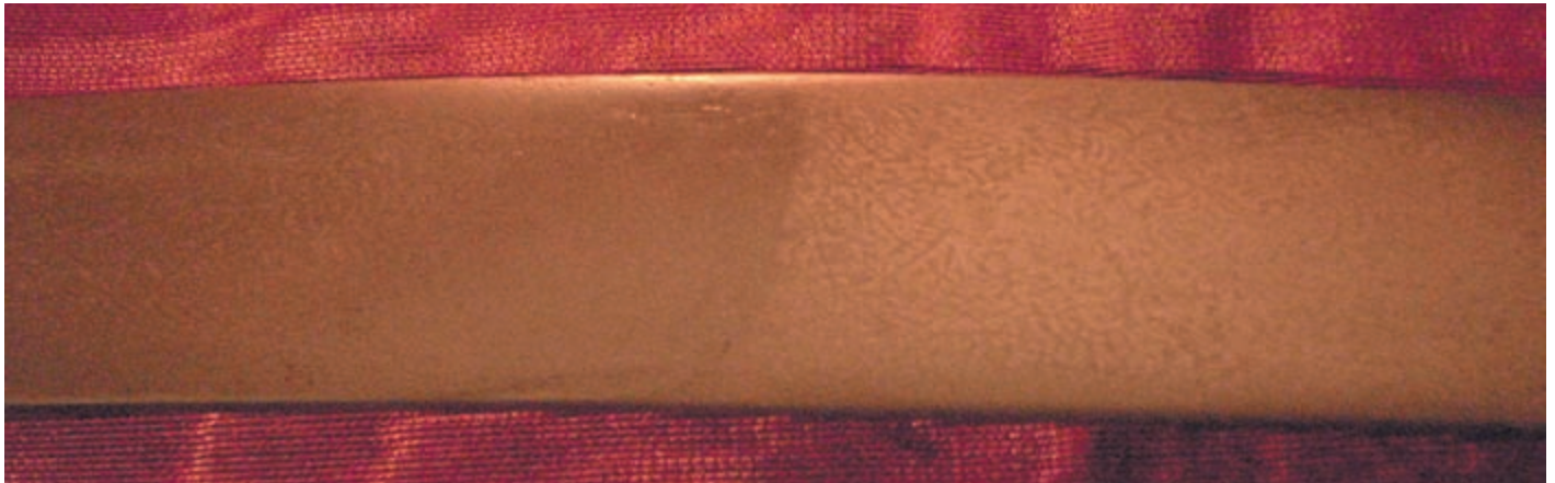
Рис. 1. Область сварки двух полос булатного клинка
