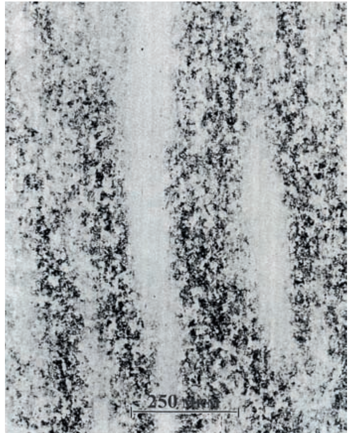
Рис. 8. Макроструктура булата со слоями металла, обогащённого фосфором
