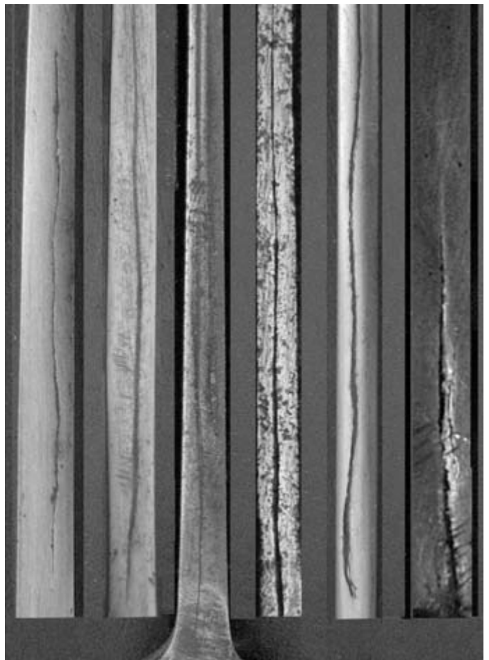
Рис. 2. Швы кузнечной сварки на обухах булатных клинков
