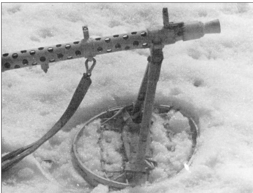
«Решето», применявшееся немецкими пулемётными расчётами, воевавшими в России. Кожух пулемёта MG34 выкрашен в белый цвет
