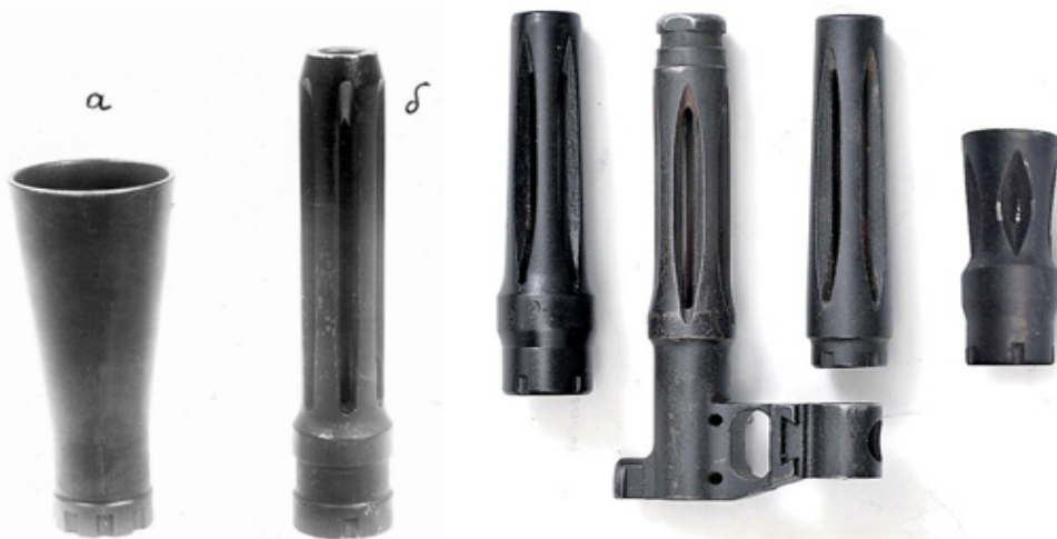
Штатный конический (а) и опытный щелевой (б) пламегасители ПК и серийные пламегасители ПК, СВД, АКМ(С)Л и РПК(С)Л, разработанные на его базе. Крайний справа – короткий пламегаситель ПКМ комбинированного типа (конический, пятищелевой), которым стали комплектоваться пулемёты с конца 70-х годов. Ниже приведены фото дульного пламени при стрельбе с коническим (слева) и опытным щелевым пламегасителем
