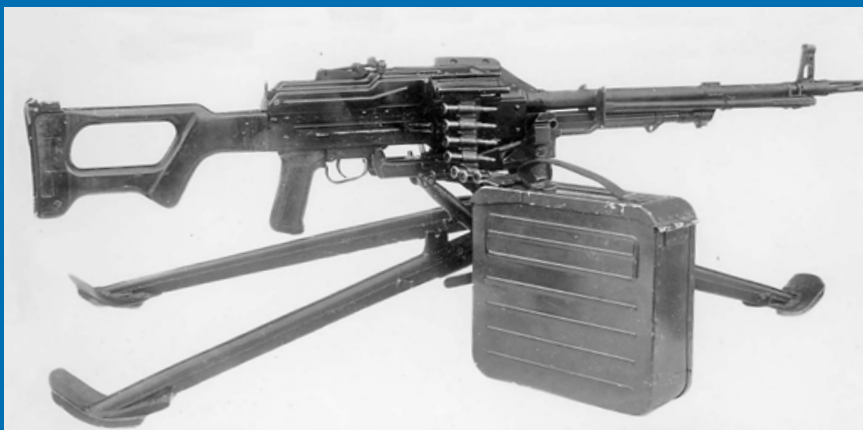
Пулемёт 6П6М с сошками на газовой трубке и на стволе, на дополнительных сошках на прикладе и на станке ТКБ-616 Степанова (вторые полигонные испытания)
