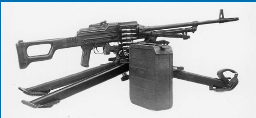
Модернизированный пулемёт 6П6М на сошках и на станке Саможенкова (первые полигонные испытания)
