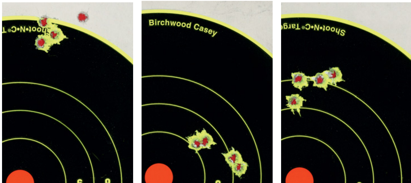
Стрельба из винтовки Bushmaster ACR на дистанции 100 м сидя с упора патронами «Кентавр» (масса пули 3,6 г). Точка прицеливания – центр мишени (красная марка). Оружие к нормальному бою приведено ровно настолько, чтобы попадать в мишень. По серии снимков приведённых здесь в натуральную величину (масштаб 100 %) хорошо видно смещение средней точки попаданий, которое явно проявляется при снятиях/установках ствола. Таким образом, допустимо оценивать реальную кучность стрельбы, суммируя результат получается приемлемый для боевого оружия, но в разы хуже показателя отдельных групп
