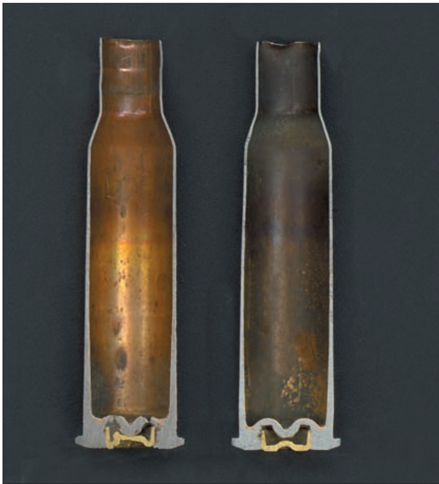
Разрезы 7,62-мм гильз. Гильза патрона к пулемёту ШКАС (слева), в отличие от обычной (справа) имеет более толстые стенки и донную перегородку. Масштаб 2:1
