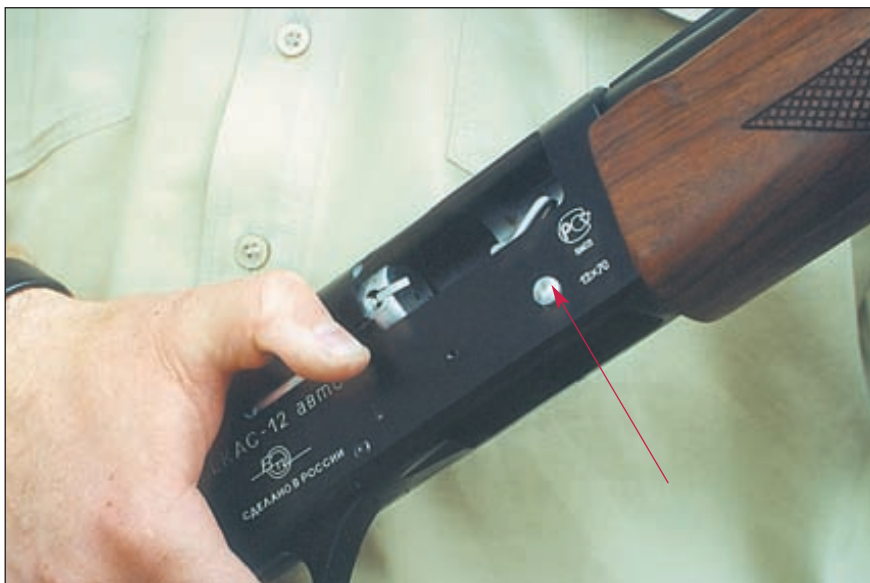
Стрелкой на фото показана кнопка затворной задержки. Флажок отсекаателя располагается на левой стороне ствольной коробки
