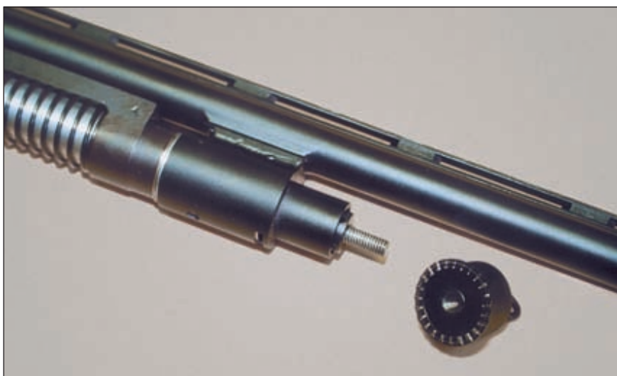
Так выглядит «Бекас» без цевья с новым газовым двигателем, в конструкцию которого введён автоматический газовый регулятор
