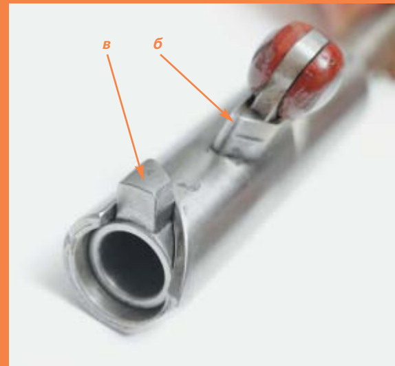
Полый ударник (а) движется внутри тела затвора. При движении назад затвор подтормаживается за счёт взаимодействия выступа (б) со скосом ствольной коробки и поверхности в задней части с выступом (в) ударника
