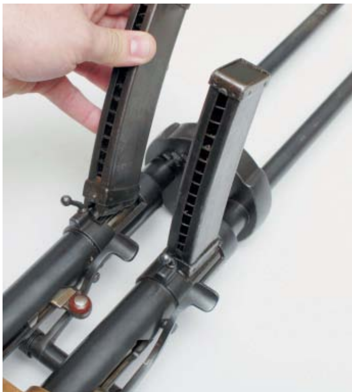
Присоединённые магазины фиксируются поворотными замками
