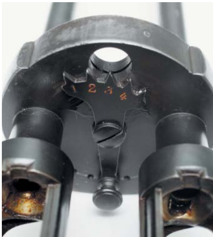
Мушки для различных дальностей стрельбы расположены на поворотном секторе
