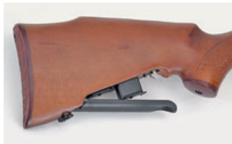
Аналогично карабину «Соболь», приклад SM-2КО имеет гнездо для размещения двух запасных магазинов
