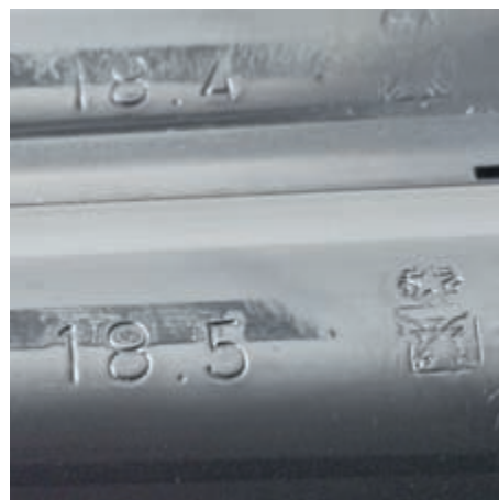
Маркировка ствольного блока ружья Bettinsoli с различными значениями диаметров каналов стволов
