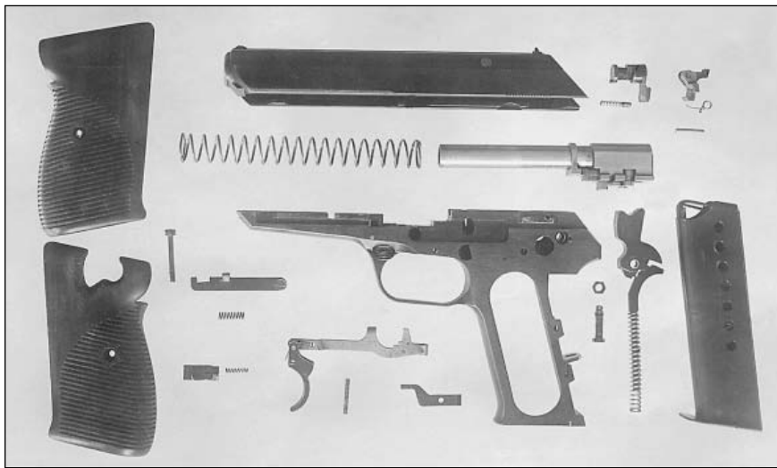
Полная разборка чехословацкого пистолета, который первым проходил испытания
