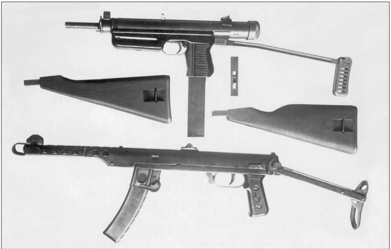
7,62-мм чехословацкий пистолет-пулемёт (вверху) и ППС-43. «Чех» мог комплектоваться складным металлическим или с двумя вариантами постоянных деревянных прикладов. При смене ствола и магазина под патрон 9x19 для надёжного крепления магазина в рукоятке использовался металлический вкладыш
