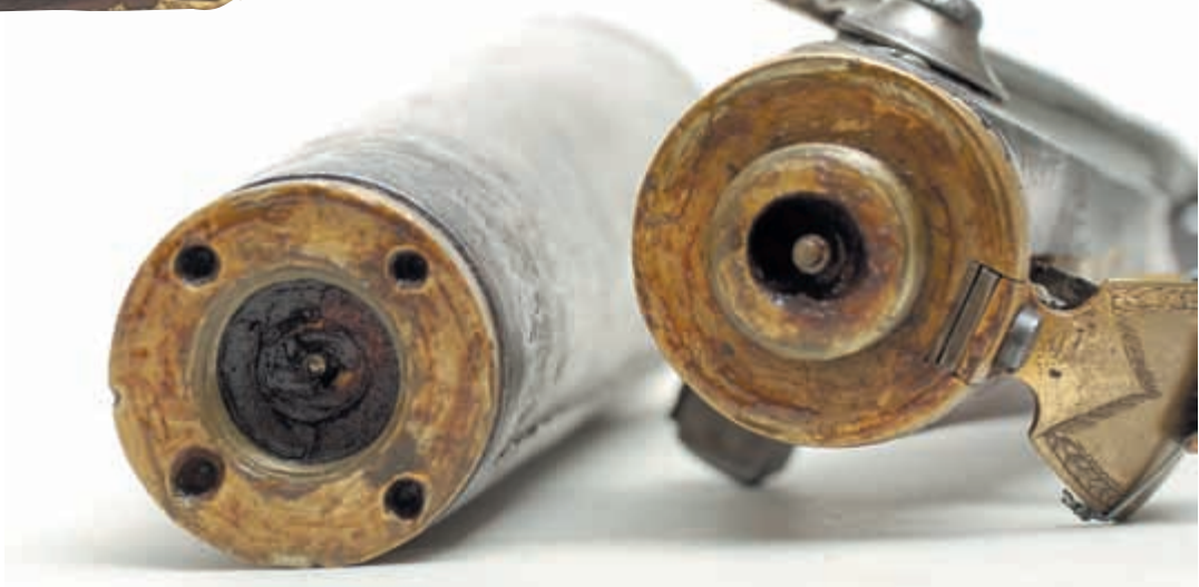
Клапанное устройство имеет кожаные уплотнения и требовало тщательного ухода
