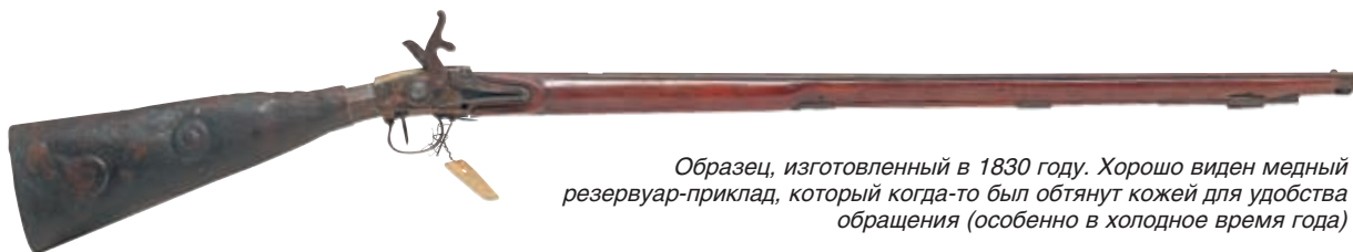
Образец первой трети XIX-го века с бронзовым стволом и встроенным насосом, шток которого располагается в прикладе
