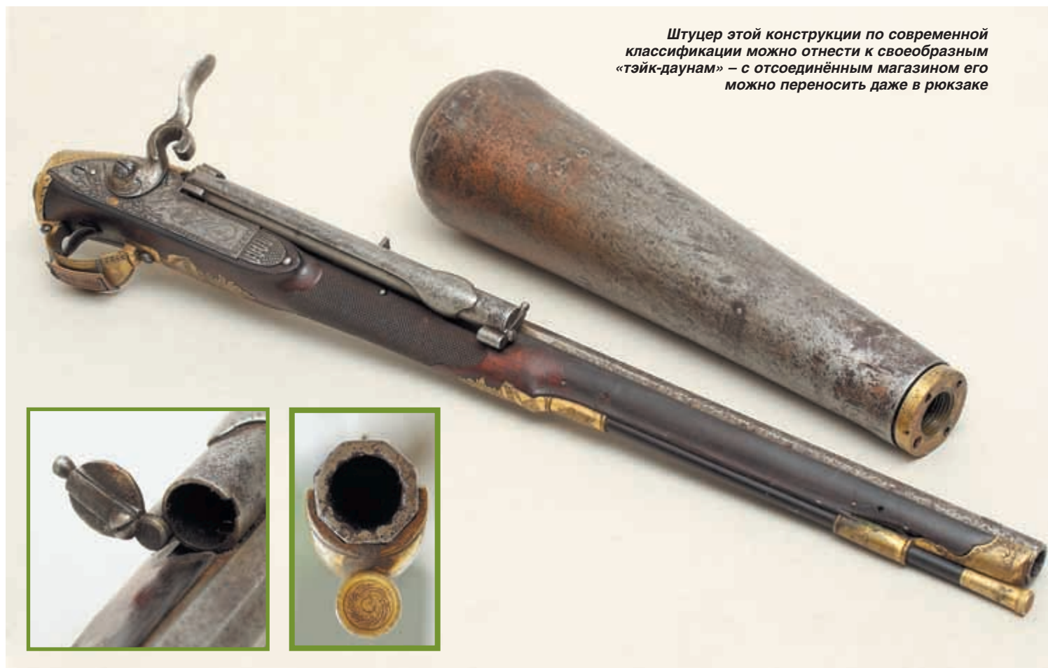
Клапанное устройство имеет кожаные уплотнения и требовало тщательного ухода
