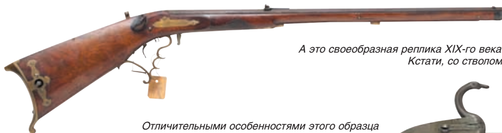
Образец, изготовленный в 1830 году. Хорошо виден медный резервуар-приклад, который когда-то был обтянут кожей для удобства обращения (особенно в холодное время года)
