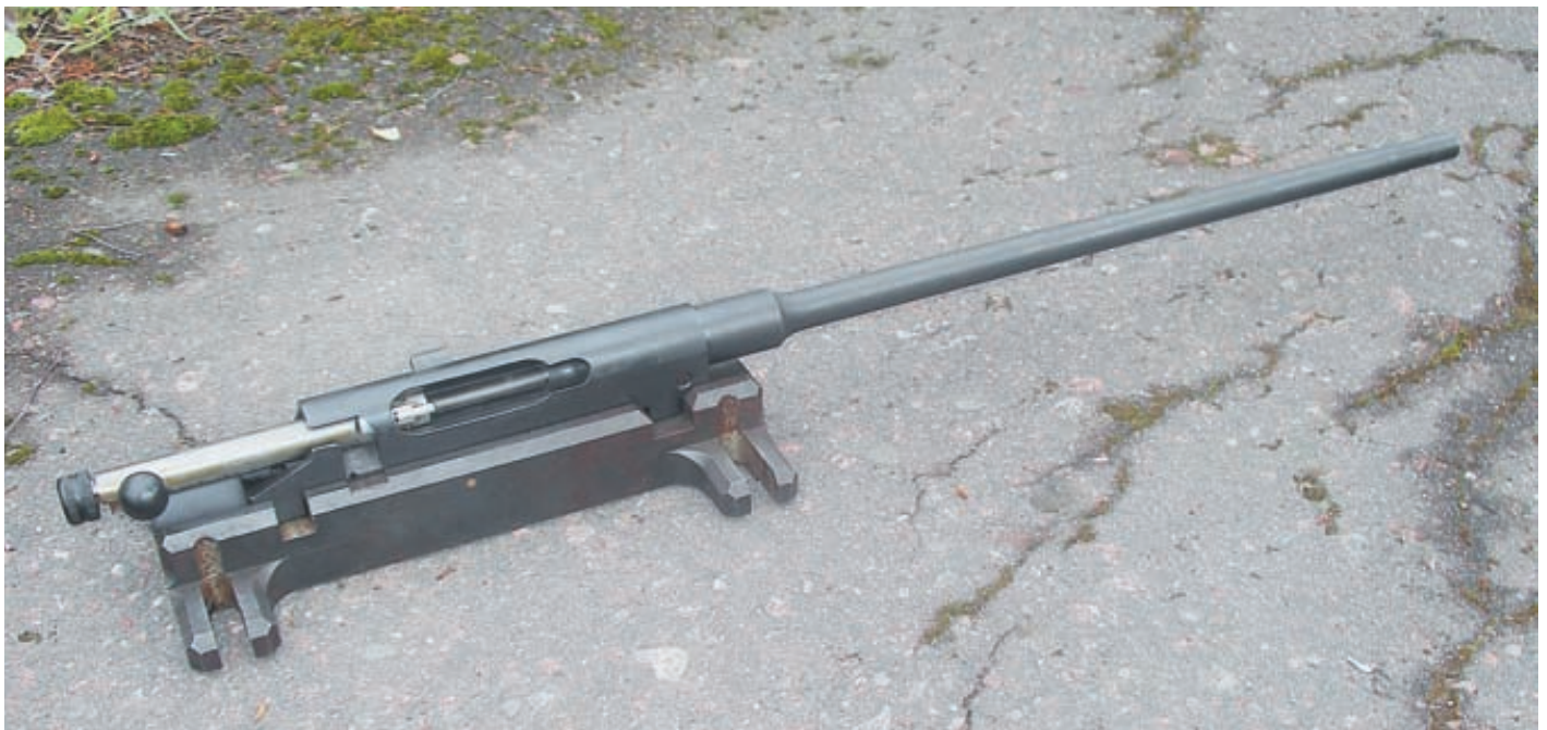
Баллистическая кучностная установка БК-08 (Ц)
