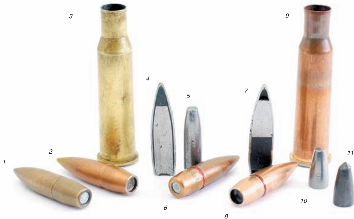
1 – пуля целевого патрона, 2 – тяжёлая пуля «Д», 3 – латунная гильза, 4, 5, 6 – пуля со стальным сердечником (разрез, сердечник, внешний вид) 7, 8, 10 – снайперская пуля ПС (разрез, внешний вид, сердечник), 9 – биметаллическая гильза ГЖ, 11 – сердечник пули патрона 7Н14 (обточка конуса головной части выполнена несоосно, что не может способствовать хорошей кучности стрельбы. Обнаружено при демонтаже пули)
