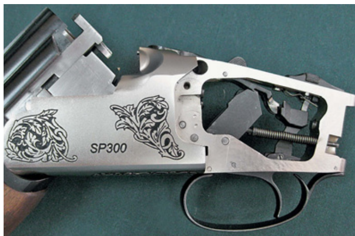
У SP300 односпусковой УСМ. Переключение на второй ствол происходит независимо от результата первого нажатия – выстрела или осечки
