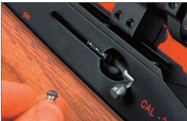
Трубчатый магазин вместимостью 9 пуль винтовки Logun Mk II (фото слева) расположен на левой стороне ствольной коробки. Для отсоединения барабанного магазина винтовки Logun Axsor необходимо нажать защёлку и извлечь магазин
