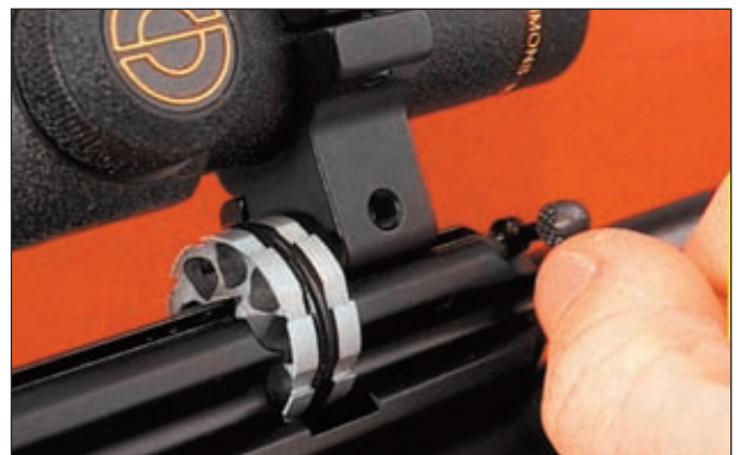
Трубчатый магазин вместимостью 9 пуль винтовки Logun Mk II (фото слева) расположен на левой стороне ствольной коробки. Для отсоединения барабанного магазина винтовки Logun Axsor необходимо нажать защёлку и извлечь магазин
