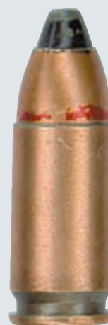
Патрон 7Н21 (М 2:1). Патрон герметизирован красным лаком-герметизатором по стыку пули с гильзой и по окружности капсюля. Для защиты от коррозии выступающая из оболочки часть сердечника окрашена чёрным лаком
