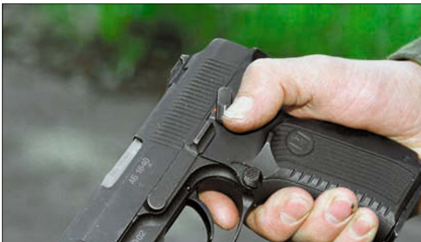
Снятие затвора с затворной задержки
