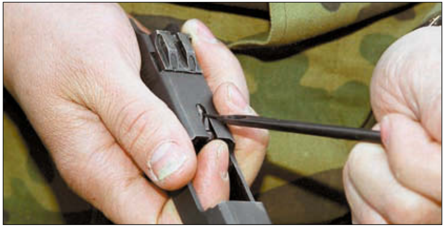
Для извлечения выбрасывателя необходимо шомполом отжать гнеток выбрасывателя и, опустив зуб выбрасывателя вниз, извлечь выбрасыватель из гнезда
