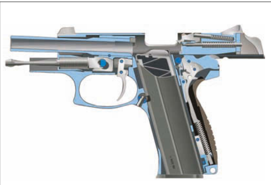
Взаимное расположение частей пистолета после израсходования всех патронов. Затвор находится в крайнем заднем положении на затворной задержке
