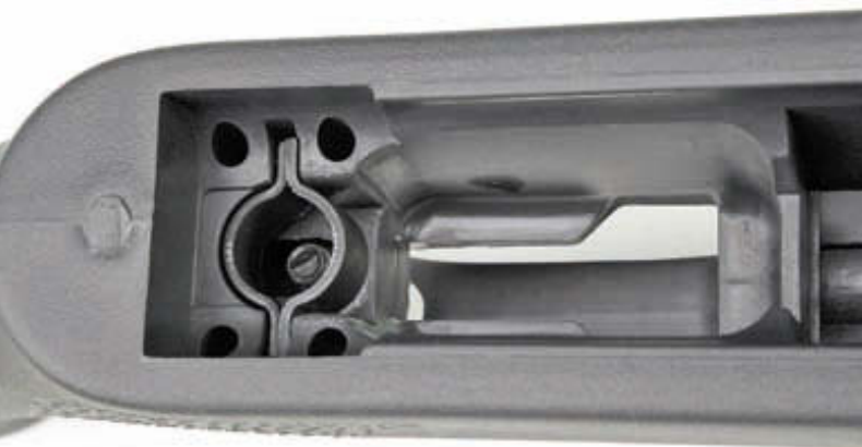
Положение обоймы для промежуточной резьбовой втулки в ложе винтовки
