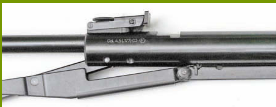
Автоматический предохранитель включается, как только рычаг взвода отведён на угол 15°. Видно, что пластина предохранителя своим нижним выступом блокирует перемещение выступа ролика спускового крючка в прорези корпуса СМ
