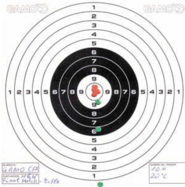
Результаты стрельбы на 10 м с упора. Открытый прицел, пять выстрелов винтовочными пулями H&N Finale Match, скорость 150 м/с. Пробоины, помеченные зелёным цветом – результат приведения винтовки к нормальному бою; помеченные красным цветом – зачётная серия
