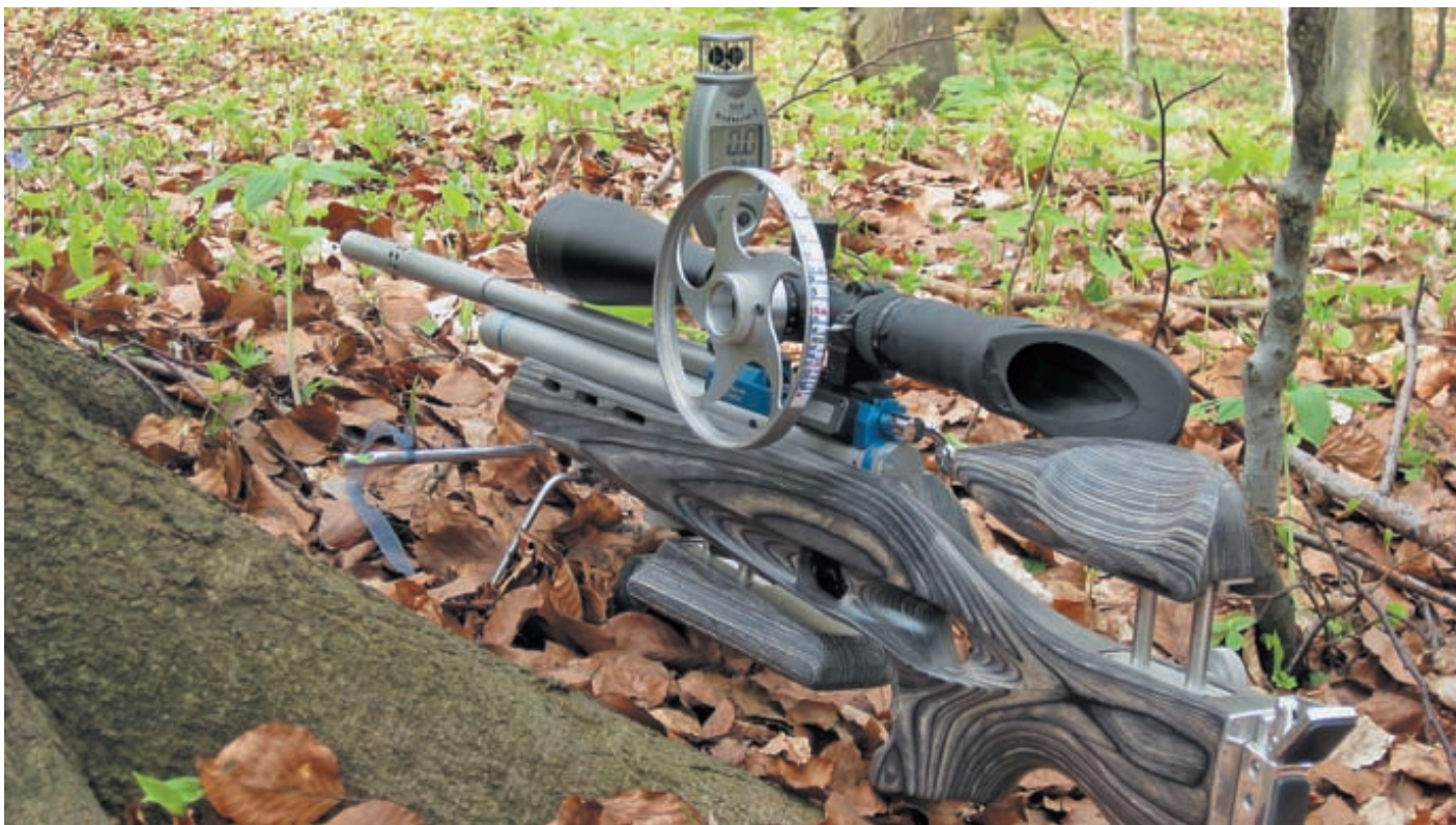
Винтовка Daystate MK4 Grand Prix в своей конструкции содержит большое количество электроники. Винтовка имеет встроенный хронограф и способна показывать на дисплее скорость, давление в баллоне, количество выстрелов, и т. д.
