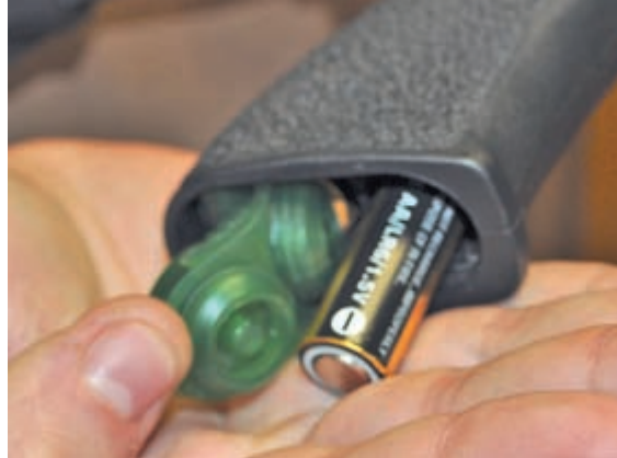
Рукоять с отсеком для батареек
