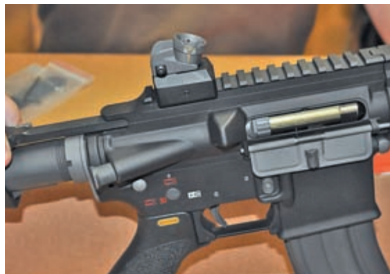
При отводе затвора в крайнее заднее положение можно наблюдать поршень в гильзовыводном окне
