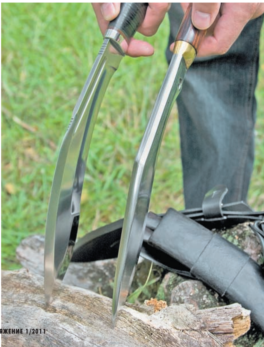
В рукоятке кукри «Джунгли» (справа) предусмотрено отверстие под темплек, который компенсирует отсутствие развитого навершия рукояти, присущего непальским кукри (слева)
