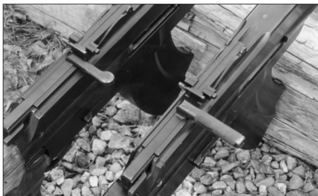
В зависимости от года выпуска на пулемётах L/S 26 встречались два различных типа рукояток перезаряжания. На фото справа пулемёт более позднего выпуска
