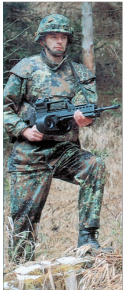
Вариант ручного пулемёта G36 (Light Support Weapon) может комплектоваться двоянным барабанным магазином вместимостью 100 патронов
