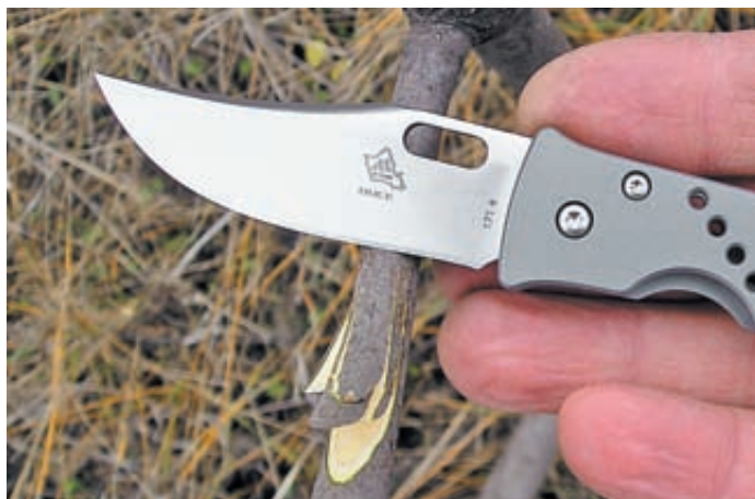
Клинок Mayu Waitea, имеющий двояковогнутый профиль в сечении, при одинаковой толщине обуха наиболее уязвим при боковых нагрузках по сравнению с другими профилями
