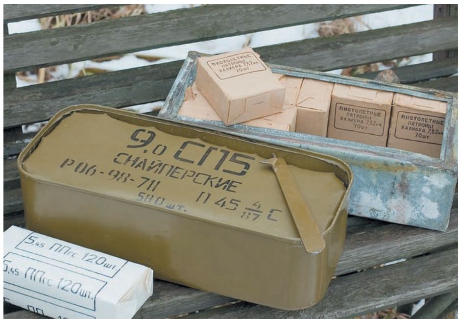
Вскрытые металлические коробки. Справа паяная из оцинкованного железа (в обиходе «цинка»), слева – штампованная с закатной крышкой, на которой лежит нож для её открывания. В каждом ящике помещены две металлические коробки и один ключ. Для обеспечения герметичности штампованные металлические коробки закрываются крышкой и закатываются аналогично стеклянным банкам с металлической крышкой при заготовках консервов. Альтернативной металлическим коробкам служат влагонепроницаемые пакеты с шестью пачками патронов (180 шт. 5,45-мм патронов или 120 шт. 7,62-мм патронов), укладываемые прямо в ящик
