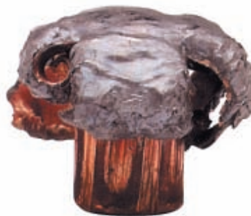
Вверху. Пули Remington Core-lokt Внизу. Так выглядит пуля Core-lokt после попадания в цель
