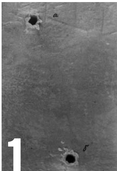
Выходные отверстия на 10-см петролатумном блоке: 1 – 7,62-мм пуля патронов обр. 1943 г., 2 – 5,6-мм пуля, изготовленных по типу пуль патронов «Ремингтон»
