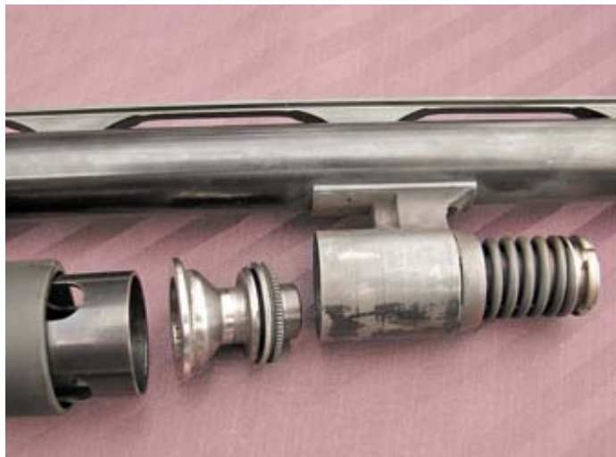
Детали газового двигателя нового ружья Beretta
