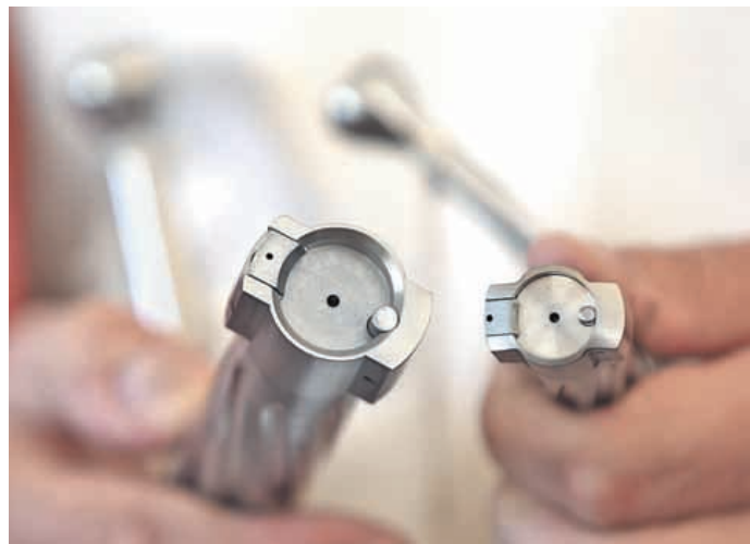
Сравнение размеров чашечки затвора затворных групп ВАТ для калибра .50 ВМГ и .338 Лапуа Магнум
