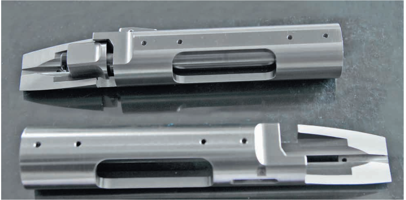
Затворные группы Farley из стали 17-4PH с правым и левым портом. Рукоятка перезарядки ещё не припаяна к затвору
