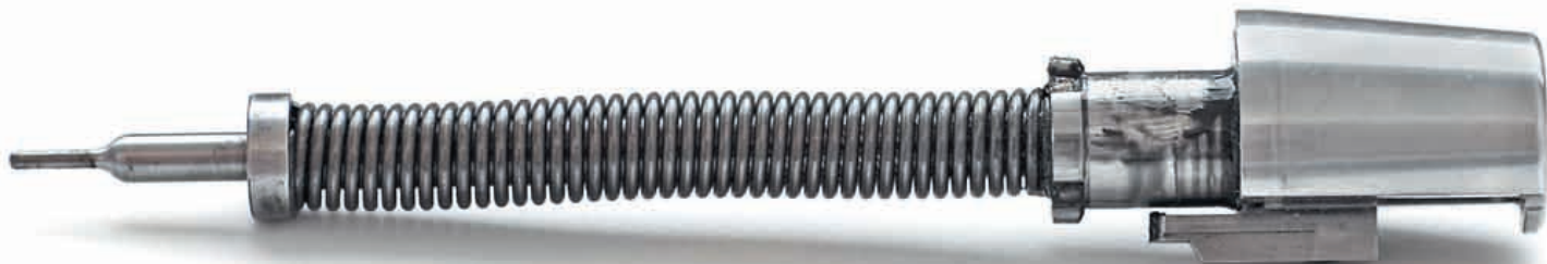
Ударник, муфта и шептало VAT в сборе. Конструкция затвора компании VAT не предполагает использования резьбовых соединений при сборке. Ударник удерживается двумя выступами которые хорошо видны на фото. За выступами хорошо видна центрирующая поверхность, которая обеспечит соосность ударника после сборки затвора
