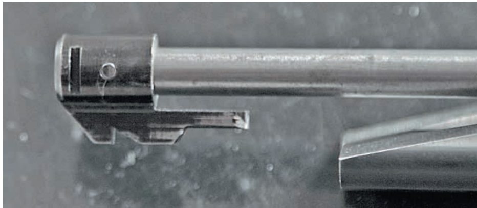
Шептало конструкции Remington 700 в затворной группе Farley. Цельная деталь, ударник закреплен штифтом
