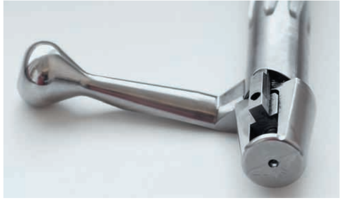
Затвор в сборе, боевая пружина спущена. На задней части муфты видна гравировка летучей мыши – фирменного знака VAT machines
