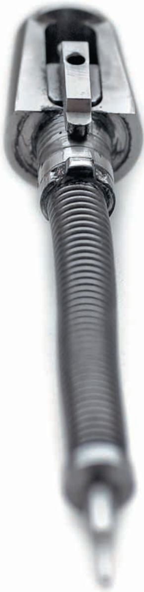
Ударник с соединительной муфтой и шепталом фирмы VAT. Обратите внимание, что зацеп шептала выполнен отдельной деталью и затянут винтом
