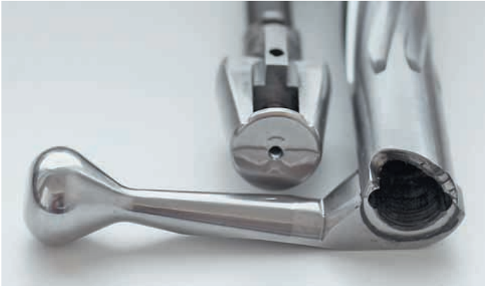
Ударник в сборе и тело затвора перед соединением. Рукоятка перезарядки припаяна серебром
