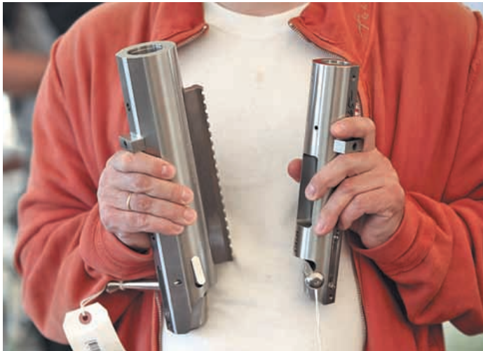
Затворные группы ВАТ для .50 ВМГ и .338 Лапуа Магнум. Затворная группа ВАТ для .50 ВМГ – самая крупная в их производственной линейке, длина почти 30 см, а вес около 3 кг
