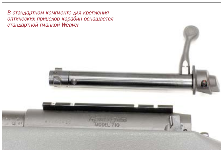
Затвор карабина обеспечивает надёжное запираение на три боевых упора
