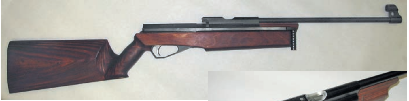
Пневматическая винтовка, созданная на базе спортивного пистолета ИЖ-46
