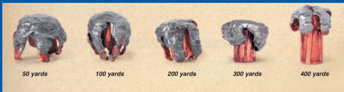
Так раскрывается пуля Core-Lokt Ultra Bonded при попадании в цель на различных дистанциях стрельбы
