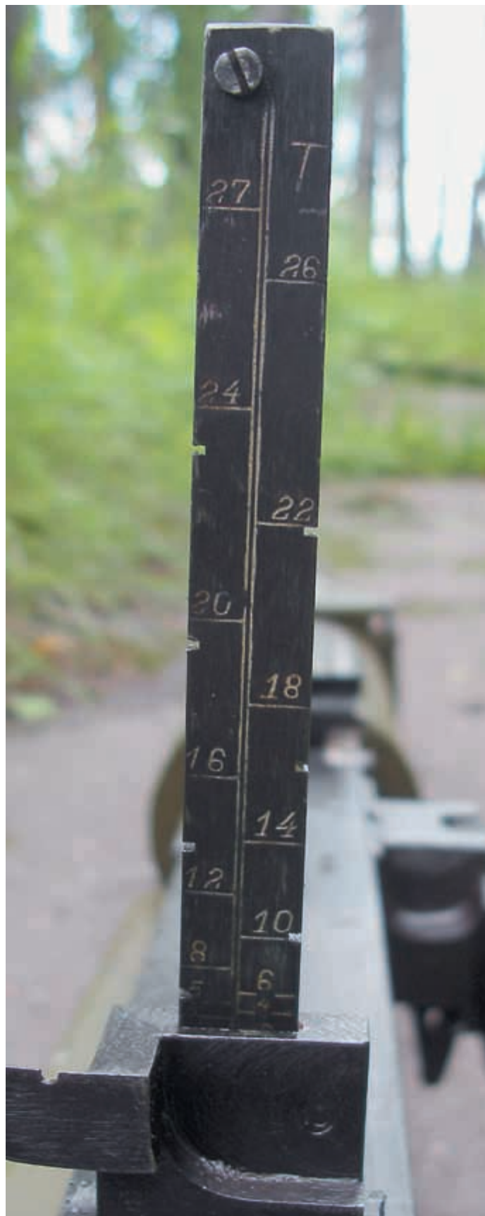
Стойка прицела модернизированного пулемёта «Максим», шкала с маркировкой «Т» для тяжёлой пули «Д»
