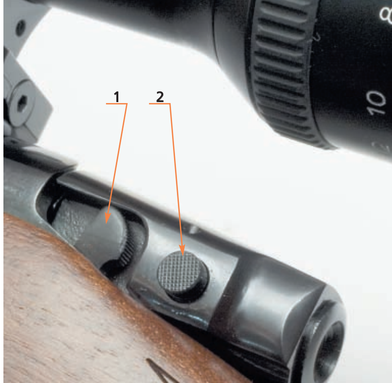
Слева от затвора располагается рычаг задержки затвора (1), а рядом с ним на затворе – кнопка фиксации муфты (2)
