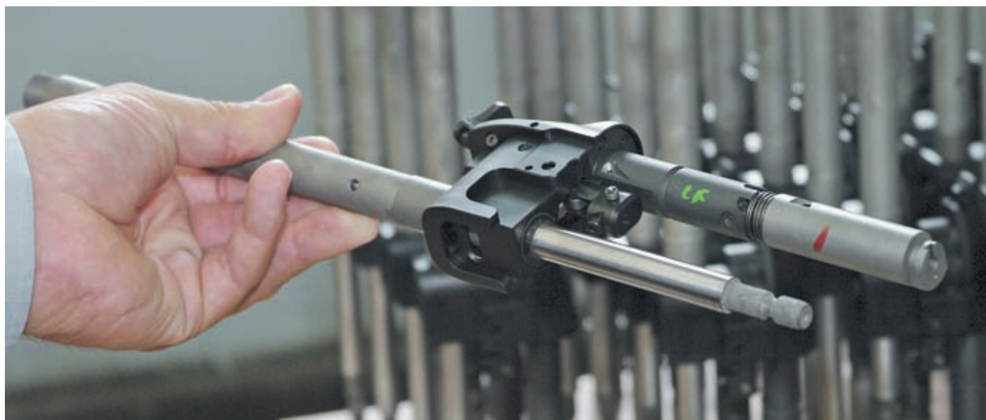
«Скелет» Semprio объединяет подвижный механизм, затыльник затворной коробки и остов затвора
