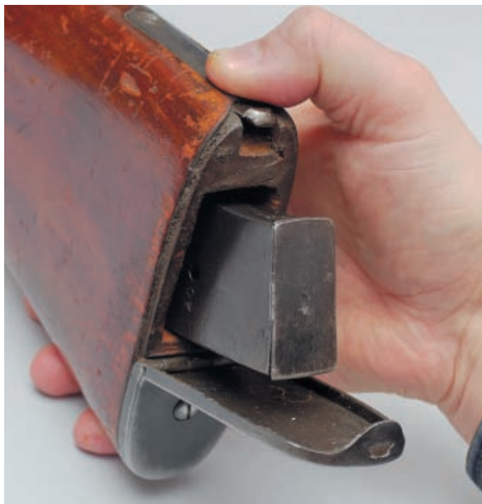
При отделении стреляющего устройства часть спускового механизма остаётся в ложе. Стрелкой показан шуруп, удерживающий переднюю рукоятку
