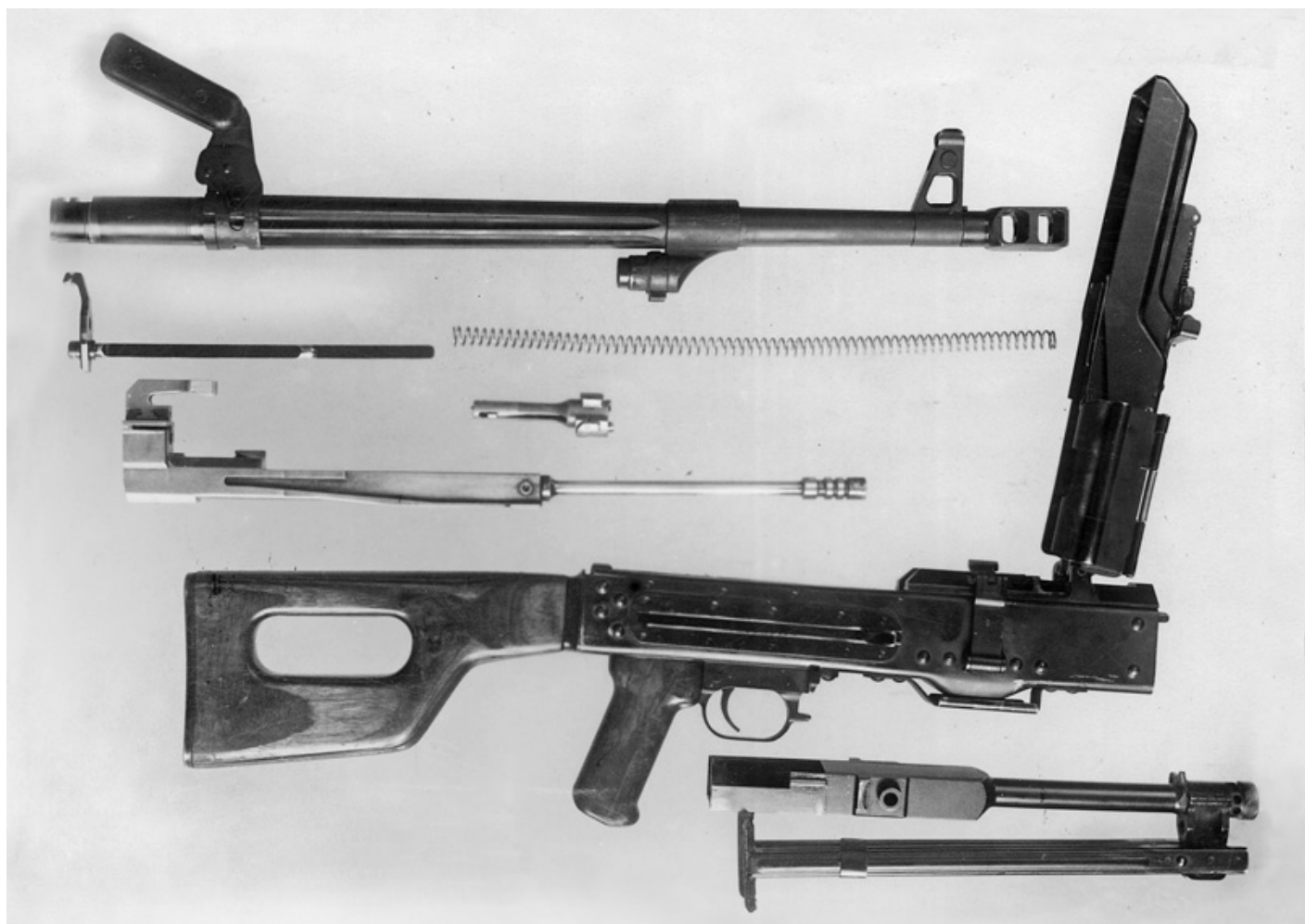
Неполная разборка Е-2; на раннем пулемёте установлен двухкамерный дульный тормоз; крышка створной коробки не имеет защёлки – её запираение производится по АК'шному выступом возвратного механизма
