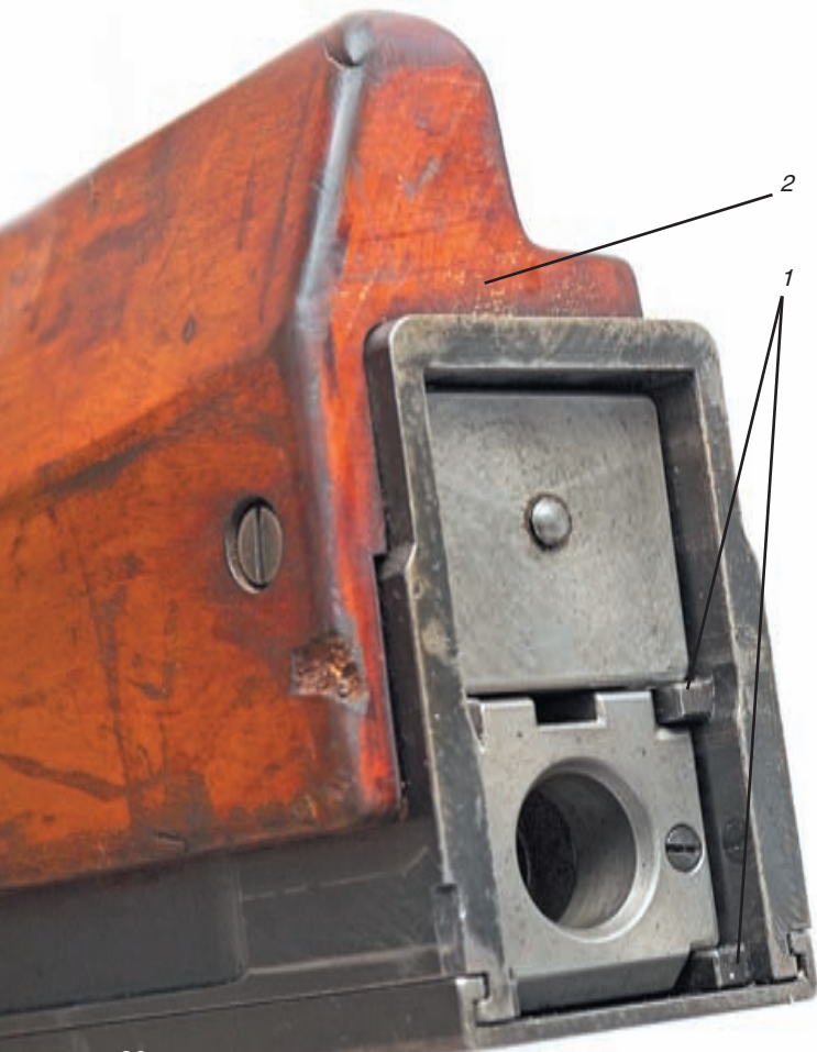
Подвижные части. Остов затвора и боевая личинка внутри ствольной коробки перемещаются по отдельным направляющим (1); деревянный подщёчник крепится с левой стороны (2)
