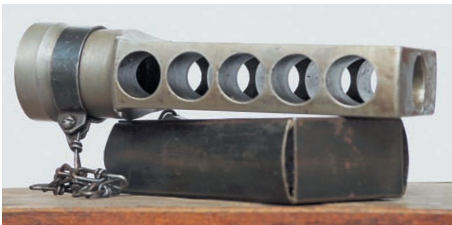
Пятикамерный дульный тормоз. Камеры образуют цилиндрические каналы перпендикулярные осевому для пролёта пули. Защитный кожух застрахован от утери цепочкой, прикреплённой хомутом к основанию
