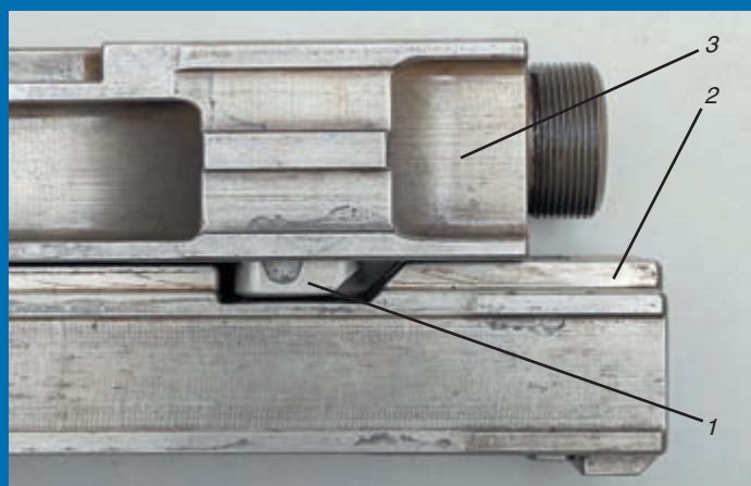
Схема запирания 1 – клиновой затвор, 2 – остов затвора, 3 – боевая личинка
