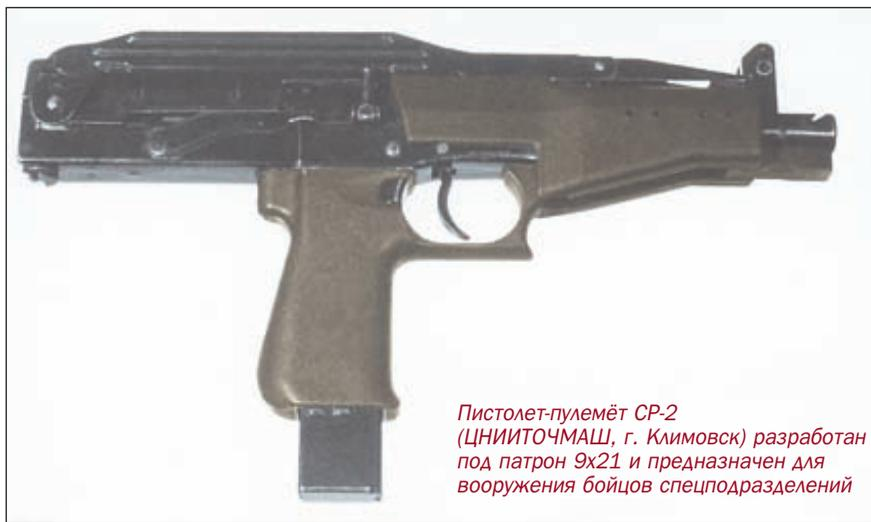
*Пистолет-пулемёт CP-2 (ЦНИИТОЧМАШ, г. Климовск) разработан под патрон 9x21 и предназначен для вооружения бойцов спецподразделений*
