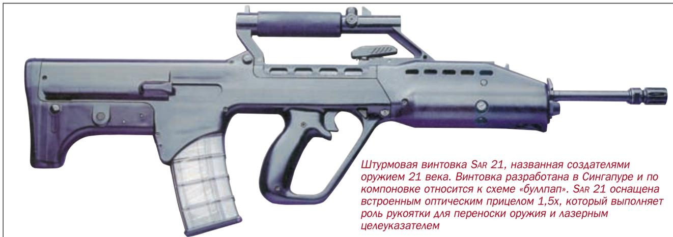
*Штурмовая винтовка SAR 21, названная создателями оружием 21 века. Винтовка разработана в Сингапуре и по компоновке относится к схеме «буллпап». SAR 21 оснащена встроенным оптическим прицелом 1,5х, который выполняет роль рукоятки для переноски оружия и лазерным целеуказателем*
