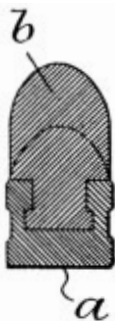
Схема пули для парадокса на которую Генри Голанд и Томас Вудвард получили патент в 1904 году
