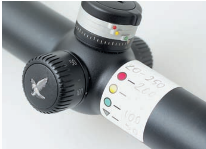
На корпус прицела можно наклеить «шпаргалку» с привязкой дистанции к каждой цветной марке
