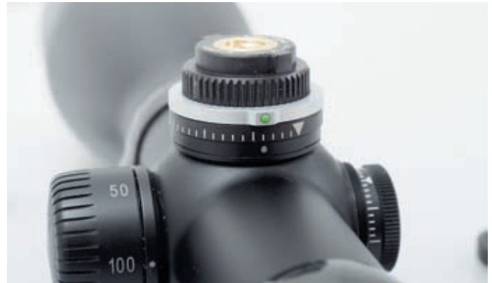
Для установки первого и каждого последующего кольца необходимо повернуть барабанчик на количество щелчков, выданное программой Swarovski
